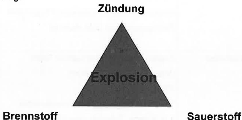
**Brennstoff:** Alle nicht O<sub>2</sub>-kompatible Materialien, auch Verschmutzungen. Je größer die Oberfläche des Materials ist, desto mehr kann oxidiert werden und desto anfälliger wird das Material für die Verbrennung.
