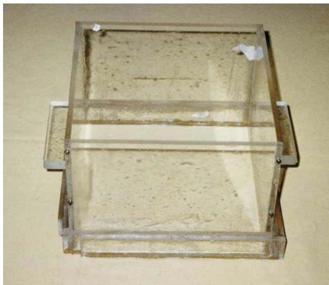
Der **Messkasten** ermöglicht die Probenahme von einer genau umrissenen Fläche.
