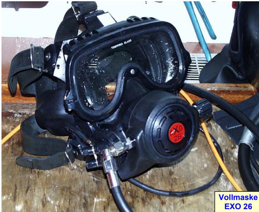
Auf dem Markt ist eine Vielzahl unterschiedlicher Vollmasken erhältlich. Hersteller sind u. a. die Firmen Dräger, Cressi, Interspiro, Kirby Morgan, Technisub und OceanReef. Im Bereich des Forschungstauchens wird meist mit der Vollmaske P04020 der Firma Poseidon (siehe Abbildung oben) getaucht. Diese Maske ist baugleich mit der Vollmaske Cressi M37, allerdings etwas preiswerter. Sie zeichnet sich gegenüber anderen Voll-
