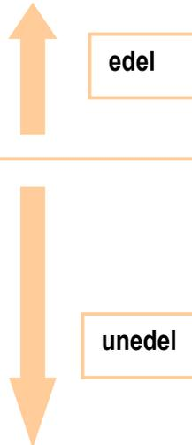
Wird Grundmaterial (z.B. Eisen) mit unedlerem Material (z.B. Zink) überzogen, entsteht bei Anwesenheit eines Elektrolyten (z.B. Seewasser) ein Element, das das unedlere Material zerstört. (Beispiel: Eisen wird geschützt, Zink zerfällt in weißes Pulver.) Die Zerstörung ist um so größer, je entfernter die Materialien in der elektrochemischen Spannungsreihe voneinander entfernt sind.
