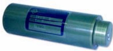
Damit sind sie relativ klein und handlich und vom Taucher gut mitzuführen. Der Pinger gibt regelmäßig ein akustisches Signal, das in seiner Leistungsstärke (0.125 W, 0.5 W, 2.0 W oder 10 W) und Frequenz (27, 37, 45 oder 54 kHz) vor dem Einsatz eingestellt wird. Bei geringer Leistung (0.125 W) und Verwendung von Lithium Batterien kann das Signal bis zu 18 Monaten gegeben werden.
