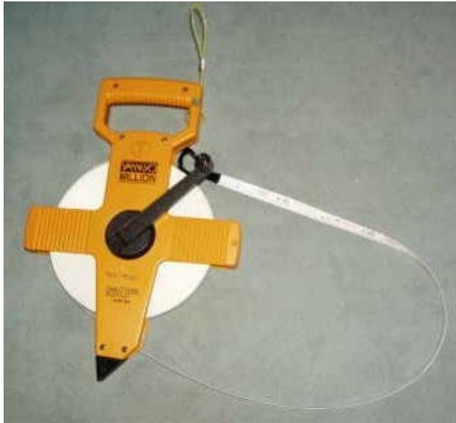
Und zum Schluss hier noch das **Messband**. Verwendet werden sollte ein Messband, das komplett aus Kunststoffteilen besteht. Ansonsten ist es sehr schnell verrostet.
