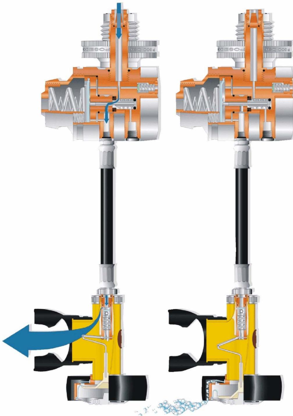
Abb.: Funktionsposter POSEIDON CYKLON (© Poseidon)
