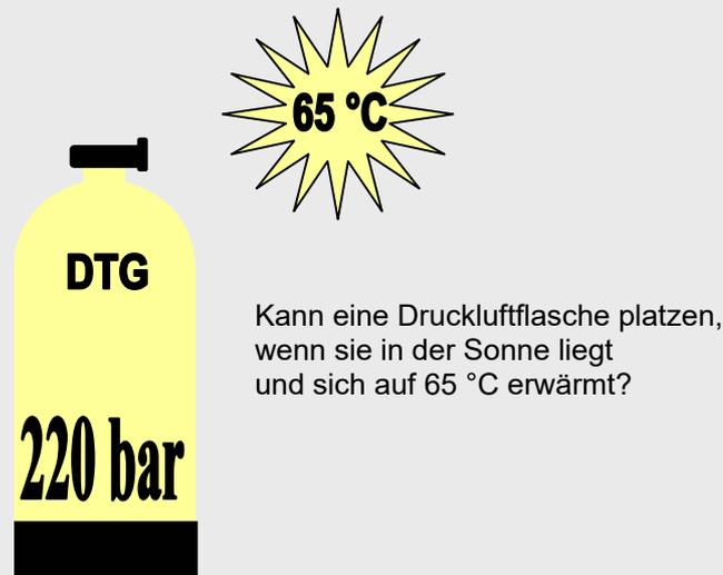
Warum kann eine Druckluftflasche, die auf einen Druck von 220 bar gefüllt wurde, nach dem Eintauchen ins Wasser nach wenigen Minuten nur noch einen Druck von 190 bar aufweisen?
