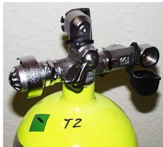
Grundsätzlich empfehlenswert sind Flaschenventile mit zwei separaten, einzeln absperrbaren Abgängen. Damit wird der gleichzeitige Betrieb von zwei von einander unabhängigen Atemreglern ermöglicht. Bei Ausfall eines Atemreglers durch Vereisung und resultierendem unkontrollierten Abströmen des Luftvorrates kann durch Schließen des jeweiligen Ventils der unnötige Luftverbrauch unterbunden werden.
