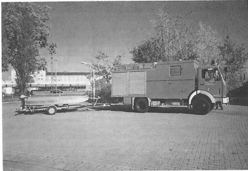
Abb. 89: Rüstwagen-Wasser mit Bootsanhänger
