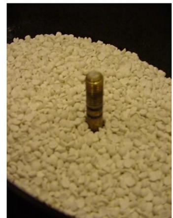
Wenn ihr Kalk aus einem neuen Kalkgebilde entnehmt, beschriftet das Gebinde deutlich sichtbar mit: Name, Datum der Erstentnahme. So kann ersehen werden, wie lange das Gebinde schon angebrochen war. Verschließt den Kalkbehälter gut, damit nicht das Kohlendioxid aus der Umgebungsluft mit dem Kalk reagiert. Weiterhin: haltet euch an die Empfehlungen des Herstellers bzgl. der Lagertemperatur des Gebindes!
