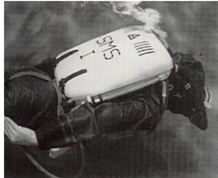
das SMS I (selbstmischendes CCR) für den Ausstieg aus Tauchglocken
