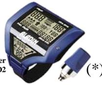
Der galvanische Sensor besteht aus einer Gold-Kathode, umhüllt von einer Fluoropolymer Membran. Die Blei-Anode ist in einer Kalium-Hydroxid Lösung eingetaucht. Die zwischen diesen Elektroden anliegende Spannung ist proportional zum Sauerstoff-Partialdruck.
