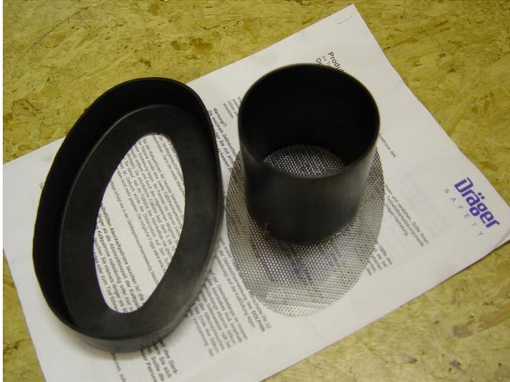
Das erste Viertel Kalk wird gut eingerüttelt, die erste Manschette gesetzt, danach das zweite Viertel Kalk, ebenfalls gut eingerüttelt und mit der zusätzlichen, zweiten Manschette gedeckelt. Darauf wird das Reduzierstück gepreßt, und mit dem Deckel regulär verschraubt. Auf die korrekte Befüllung bis zur mittleren Markierung („Teilfüllhöhe“ bei den Kalkpatronen neuerer Bauart) ist zu achten:
