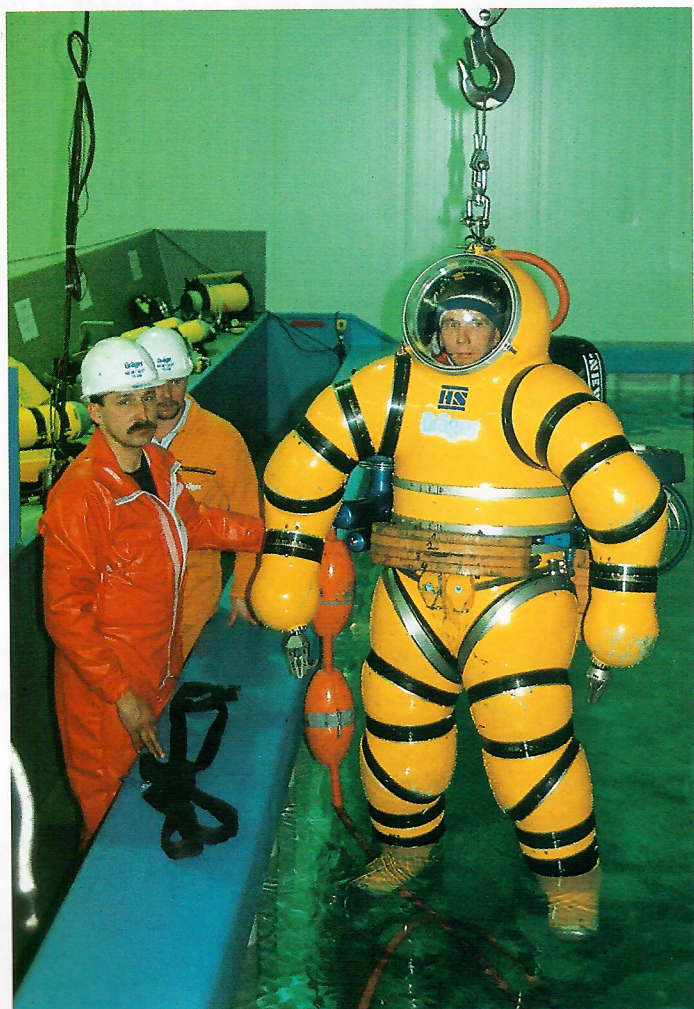
Schwerer Junge am Haken: Der Newtsuit wiegt mehrere hundert Kilo und läßt den Benutzer nicht gerade wie eine grazile Elfe aussehen ...
