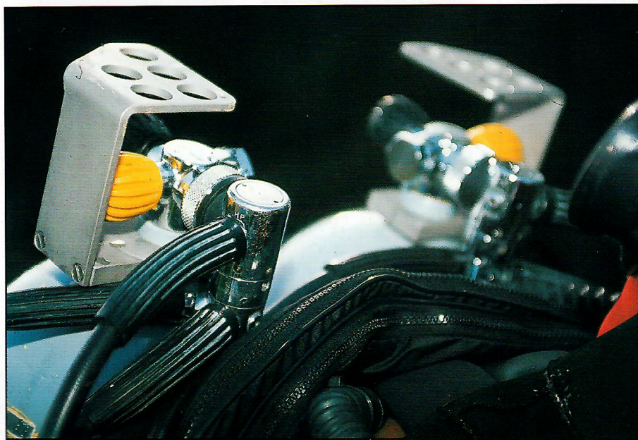
Die „Cobra-Guard“ verspricht Schutz gegen Anecken, behindert aber den Zugang zu den Ventilen und ist daher umstritten
