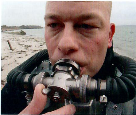
Mundstück mit Walzenschieber des russischen Kreislaufgerätes IDA 64.
