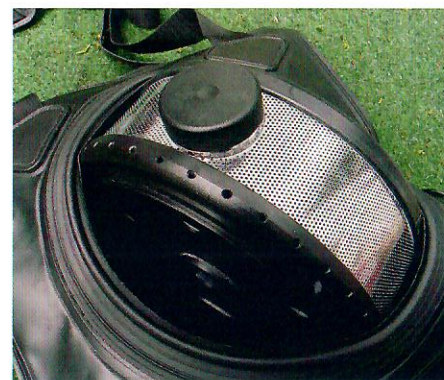
Das besondere beim Casoro 96 pro ist, dass die Kalkpatrone innerhalb des Atembeutels liegt.
