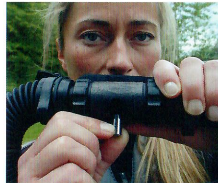
Geschlossene Walze (Schieber). Der Hebel zeigt nach unten. In dieser Position befindet sich der Schieber immer dann, wenn nicht getaucht wird. Damit wird versehentliches Eindringen von Wasser in den Kreislauf verhindert.
