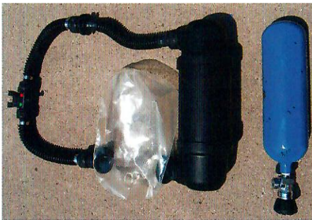
Das Innenleben eines Poseidon Sauerstoff-kreislaufgerätes. Was fehlt, ist der Druckminderer. Die recht einfache Bauweise der Geräte sollte nicht über die Gefahren beim Betrieb mit Sauerstoff hinwegtäuschen.
