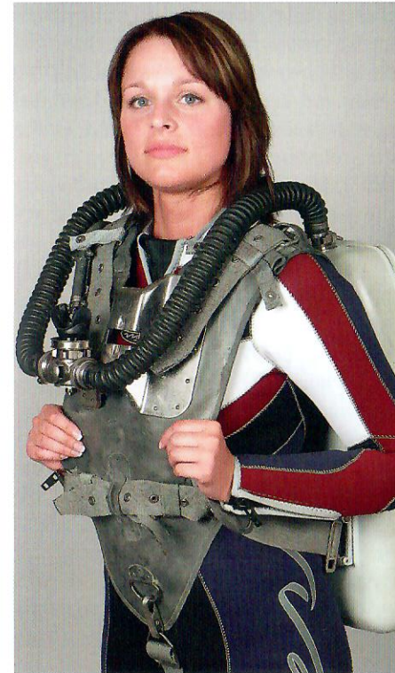
Das russische IDA 64 mit integriertem Tragesystem.
