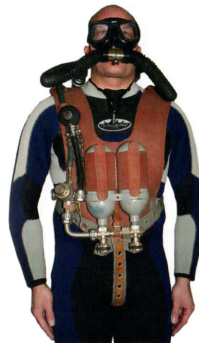
Taucher mit angelegtem Leutnant Lund II-Gerät in Seiten- und Frontalansicht.
