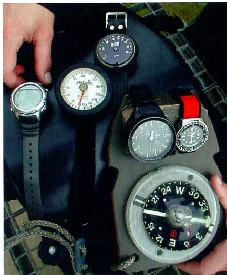
Von links nach rechts: Tauchcomputer, manueller Tiefenmesser, Kapillartiefenmesser. Darunter ein militärisches Navigationsbord mit Tiefenmesser bis maximal 16 Meter, Uhr und ein Kompass.
