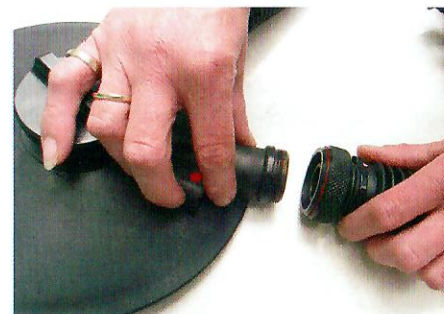
Zu sehen ist die Deckelplatte des Casoro 96 pro mit den farblich markierten Anschlüssen für die Atemschlauchgarnitur.
