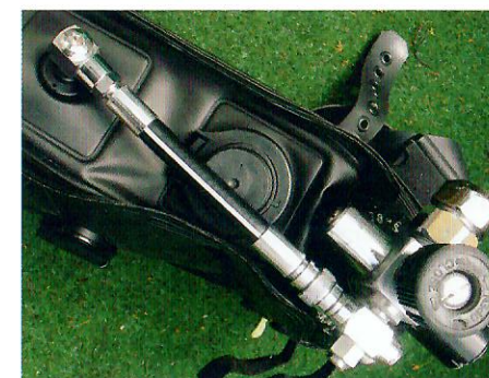
Die unter dem Atembeutel befindliche Sauerstoffflasche wird von der Schlauchverbindung gelöst.
