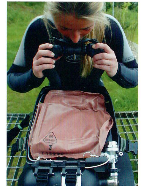
Beim Unterdrucktest zieht sich der Atembeutel deutlich sichtbar zusammen und muss dieses Vakuum auch nach dem Schließen des Mundstücks beibehalten.
