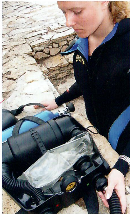
Das Kreislaufgerät wird nach jedem Tauchgang zerlegt und gereinigt. Neben der optischen Kontrolle steht die Hygiene im Mittelpunkt.
