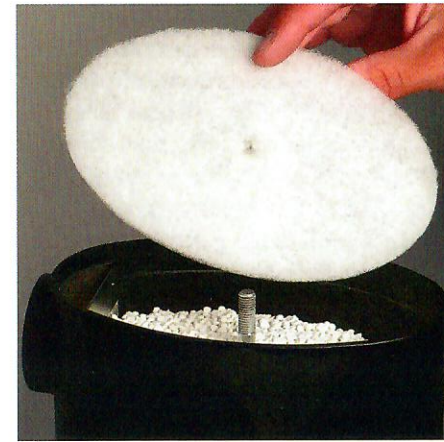
Das Bild zeigt einen selbst gebauten Feinstaubfilter, der in die Kalkpatrone eingesetzt werden kann.
