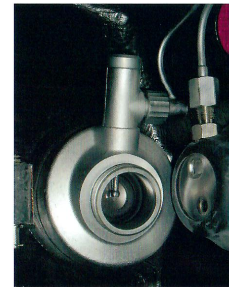
Lungenautomat eines LAR V; zu erkennen ist der Kipphebel an der Membran.
