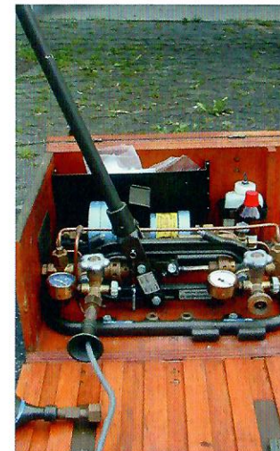
Dräger Sauerstoff-Handumfüllpumpe Model Uh 2 T. Ein stabiler Holzkasten ist Basis und Schutz des Gerätes. Die Außenabmessungen der Kiste mit der Pumpe betragen 60 cm Länge, 50 cm Breite und 30 cm Höhe.
