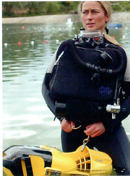
Zu sehen ist ein Scooter, der in den Schrittgurt des Harnesssystems eingehängt ist.
