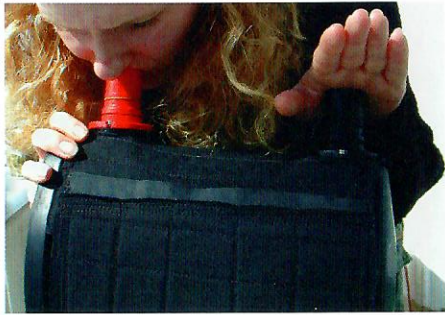
Der Dichtigkeitstest nach Befüllung des Atemkalkbehälters dient der Überprüfung des richtigen Sitzes der Deckeldichtung und etwaigen Undichtigkeiten (Haarrisse).
