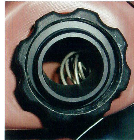
Zu erkennen ist die Spirale im Atembeutel, die ein Zusammenfallen des Atembeutels verhindern soll.
