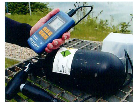
Die Überprüfung des Gemisches der Vorratsflasche ist vor jedem Tauchgang zwingend notwendig.
