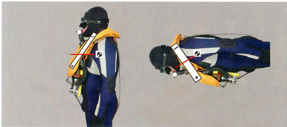
Bei der Trageweise der Gegenlunge über der Schulter ergibt sich der beste Atemkomfort.
