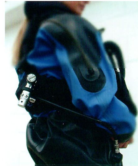
Konstantvolumenanzug mit umgebautem Einlassventil auf dem Oberschenkel.
