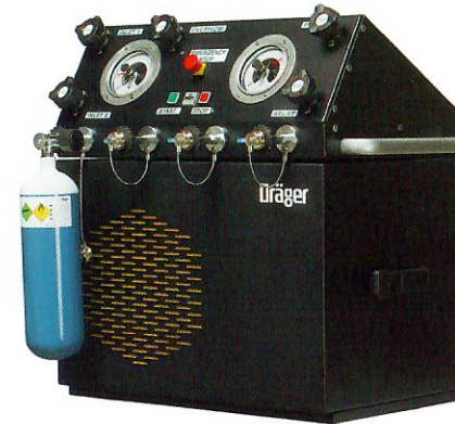
Dräger Sauerstoff-Umfüllstation DOB-M-T. Die Dräger Oxygen Booster DOB-M (mobile Version) und DOB-T (Tischversion) sind Sauerstoff-Umfüllstationen zum Umfüllen von Sauerstoff aus Vorratsflaschen PN 200 bar in Geräteflaschen. Bei dem Füllvorgang können bis zu vier Geräteflaschen gleichzeitig befüllt werden.
