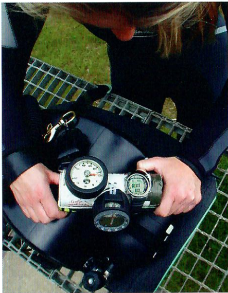
Selbstbau eines Instrumententrägers mit Tiefenmesser, Kompass und Computer. Auf der Rückseite ist ein Tauchermesser befestigt.
