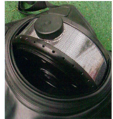
Zu sehen ist die Atemkalkpatrone des Castoro 98 Pro, die in den Atembeutel eingesetzt wird.
