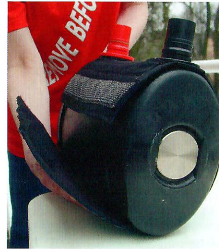
Ein Neoprenüberzieher verhindert, dass der Atemkalk bei niedrigen Wassertemperaturen zu sehr abkühlt.
