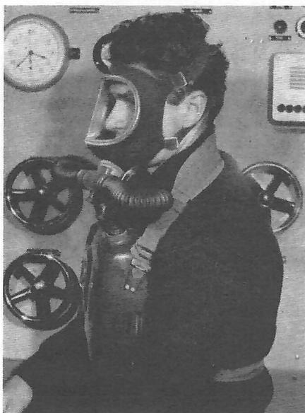
Bild 30 Hilfstaucher mit Atemgerät FGA I
