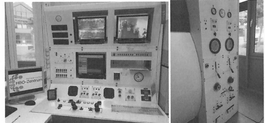
Abb. 6.1 und 6.2 Das linke Bild zeigt den elektronischen und das rechte Bild den pneumatischen Fahrstand.
