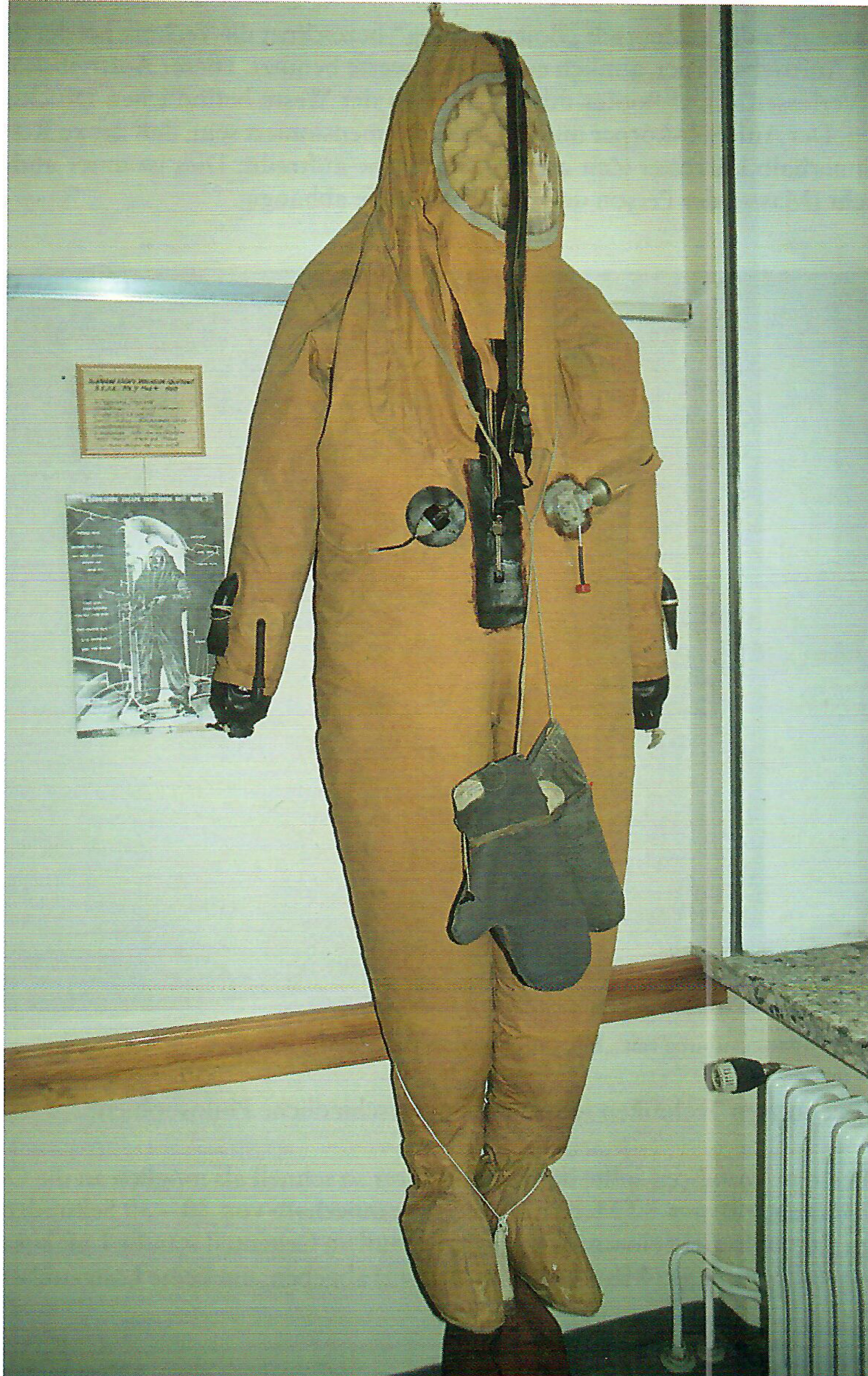
Abb. VI – 5/9: Kompletter Anzug für „hooded ascent“, inklusive Wärmeschutzfunktion
