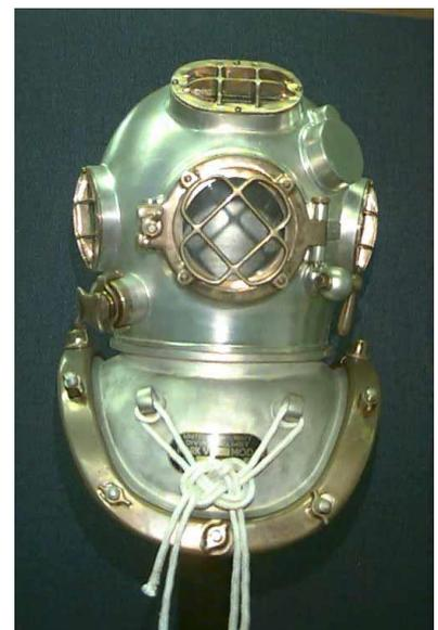
Für tiefere Tauchgänge muß Stickstoff durch Helium ersetzt werden, das benutzte Atemgas heißt : „HELIOX“. Die Abb. zeigt die Heliox-Umbauten für einen USN Mark V Helm:
