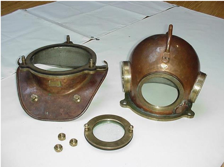
Der Helm besteht aus getriebenem Kupfer und dient dem besonderen Schutz des Kopfes. Ein Luftauslaßventil zum Trieren und Helmspülen sowie die Platte zum Anpressen der Nase für den Druckausgleich sind ebenfalls im Helm eingebaut. Kupferhelme haben normalerweise 3
