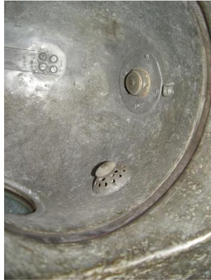
Abb. li.: Helm von hinten mit First, Anschluß für das Umbilical und das Luftauslaßventil
